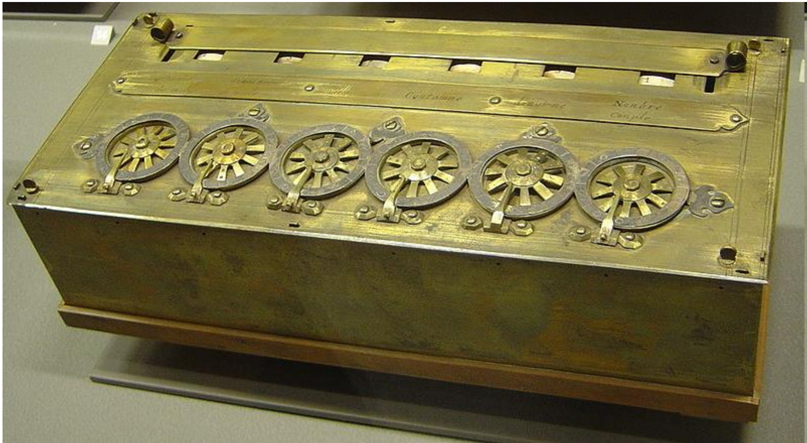
Pascal-ova mehanička mašina za sabiranje i oduzimanje
